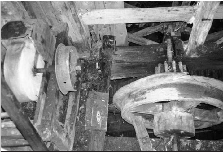
Ettl, Großwieden: Kampenräder; Riemenscheiben, Schleifstein
