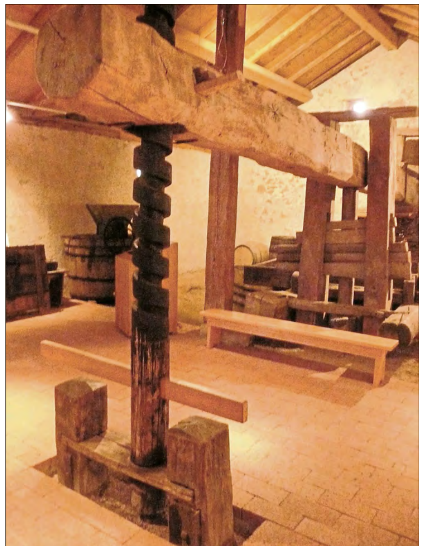
...feiert heuer den 400. Geburtstag seiner noch immer betriebsbereiten 1,9 Tonnen schweren und über neun Meter langen Baumpresse.
