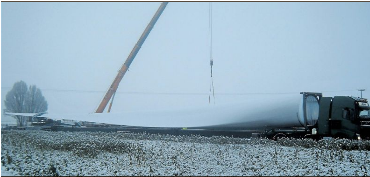
Die Rotorblätter für die Windkraftanlage beim Schiederhof sind 65 Meter lang und können bestenfalls mit einer Neigung von 60 Grad transportiert werden. (Foto: jg)
