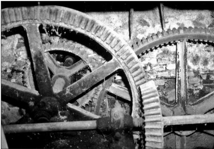
Ausschnitt aus dem Räderwerk der Frommrieder Mühle. Die Zähne waren aus Holz.
